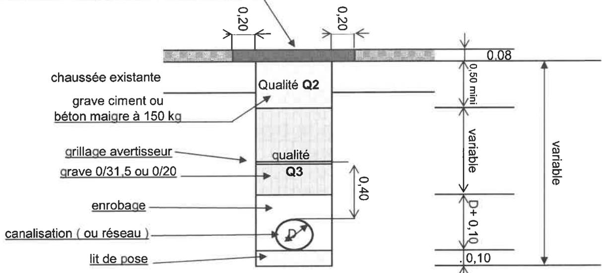
La qualité de compactage exigée pour une chaussée donnée est modulée en fonction du rôle de la couche au sein de l'ouvrage et trois niveaux de qualité sont ainsi déterminés pour les matériaux de remblaiement et les matériaux de chaussée.
