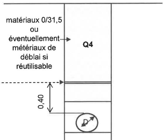
Les matériaux extraits lors de l'ouverture de la tranchée peuvent être réutilisés en remblai dans la structure B2 s'ils présentent toutes les garanties d'obtention de la qualité requise. En aucun cas, ils ne seront mis en œuvre sans l'accord du service
