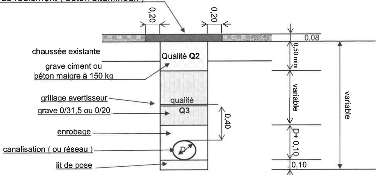
La qualité de compactage exigée pour une chaussée donnée est modulée en fonction du rôle de la couche au sein de l'ouvrage et trois niveaux de qualité sont ainsi déterminés pour les matériaux de remblaiement et les matériaux de chaussée.
