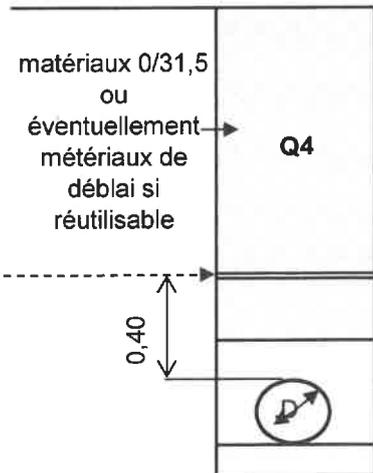
Les matériaux extraits lors de l'ouverture de la tranchée peuvent être réutilisés en remblai dans la structure B2 s'ils présentent toutes les garanties d'obtention de la qualité requise. En aucun cas, ils ne seront mis en œuvre sans l'accord du service
